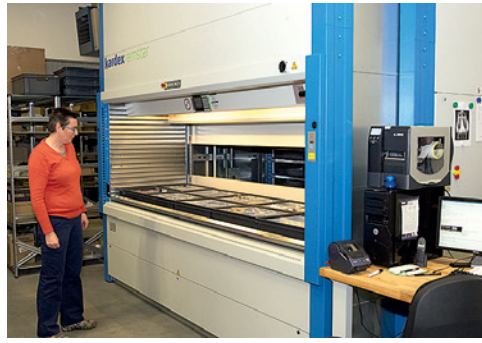
Kleine onderdelen worden opgeslagen in een Kardexkast. Met de bijpassende software zijn ze supersnel terug te vinden.
